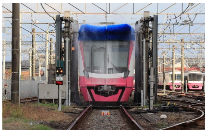
車両洗車機を通過する 80000 形電車
