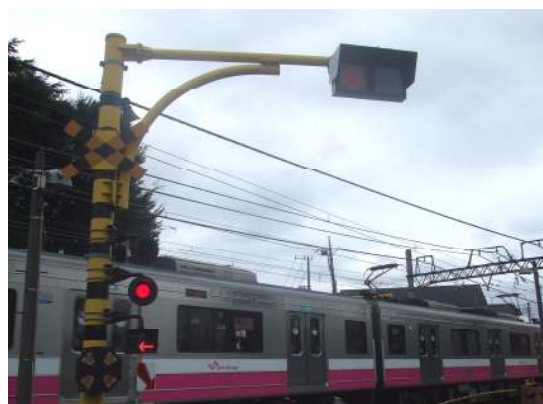
大型踏切警報機
